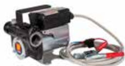
Art. 091-5081-060 Pompa 12V - cavo di alimentazione (sec. 4 mmq. m 4 lunghezza) con pinze e fusibile - 60 l/min
