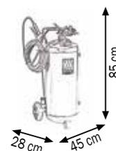
Apparecchi per la nebulizzazione di liquidi detergenti con dispositivo soluzione schiumogena. Riempiti di liquido per 3/4 della loro capacità e caricati d'aria a 6-8 bar, funzionano autonomamente senza bisogno del collegamento continuo all'aria compressa.
