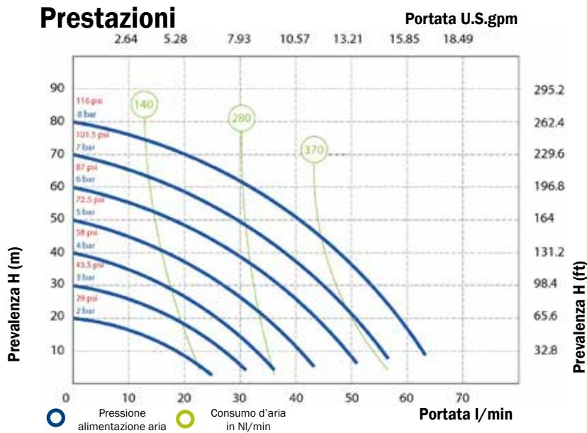
Le curve e le prestazioni sono riferite a pompe con aspirazione immersa e mandata a bocca libera, con acqua a 20° C, e variano a seconda del materiale di costruzione.
