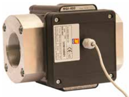
Art. 092-5170-400 Contador mecánico de impulsos MGI-400 mín-máx Caudal 15-400 l/min nr. 5,5 impulsos por litro
