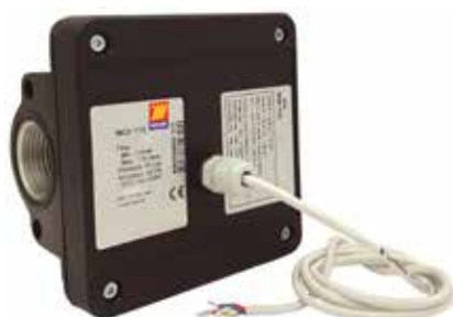
Art. 092-5170-110 Contador mecánico de impulsos MGI-110 mín-máx Caudal 5-110 l/min nr. 41 impulsos por litro
