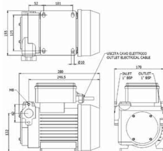
Electrobombas “CarbuMec” disponibles en cuatro versiones: 230V, 110V, 12V, 24V. Constituidas de un cuerpo de plástico y sistema antisifón de seguridad, que en caso de rotura accidental de la manguera de impulsión o de la pistola de suministro, evita el derramamiento del diésel por efecto sifón.
