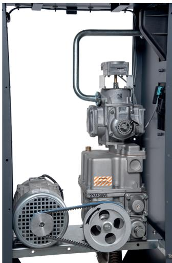
Unità pompante rotativa volumetrica autodescante ad ingranaggi
