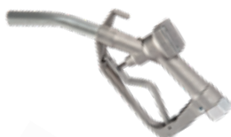
Art. 093-5200-000 Pistola manual de aluminio MC80 caudal 80 l/min
