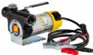
Art. 091-5081-045 Bomba 12V - cable de alimentación (sec. 4 mmq longitud 4 m) con pinzas y fusible - 45 l/min
