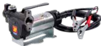
Art. 091-5081-060 Pompa 12V - cavo di alimentazione (sec. 4 mmq. m 4 lunghezza) con pinze e fusibile - 60 l/min
