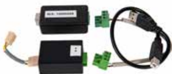
Art. 092-5350-001 Kit Connessione Lan USB - RS485 codificato
