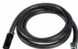
Art. 095-5440-040 Kit tubo di aspirazione con valvola Ø25 lunghezza 4 m
