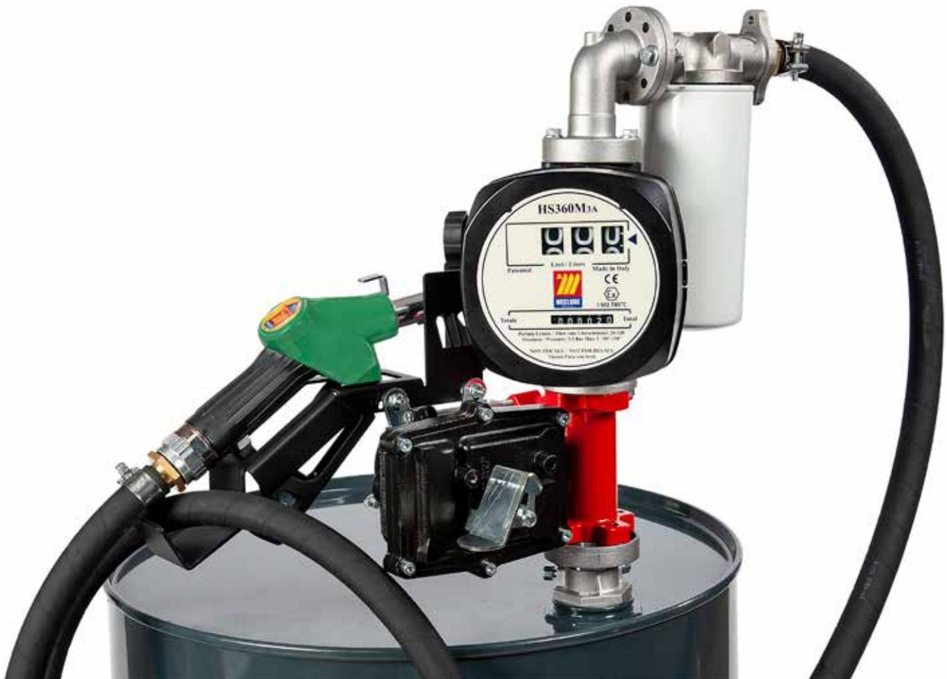
Kit per travaso benzina da fusti e cisterne ai sensi delle direttive ATEX/IECEx, con elettropompa a palette 12V - 230V. Composto da tubo di aspirazione telescopico in metallo, ghiera fissaggio da 2” con filtro per il collegamento al fusto e staffa di alloggiamento per la pistola, per facilitare l’uso del distributore.
