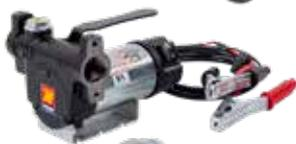
**Art. 091-5081-045** Pompa 12V - cavo di alimentazione (sec. 4 mmq. m 4 lunghezza) con pinze e fusibile - 45 l/min
