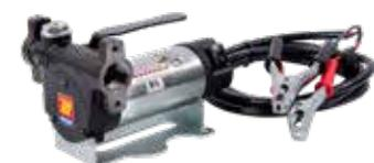
**Art. 091-5081-060** Pompa 12V - cavo di alimentazione (sec. 4 mmq, 4 m) con pinze e fusibile - 60 l/min
