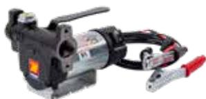
**Art. 091-5081-045** Pompa 12V - cavo di alimentazione (sec. 4 mmq, 4 m) con pinze e fusibile - 45 l/min
