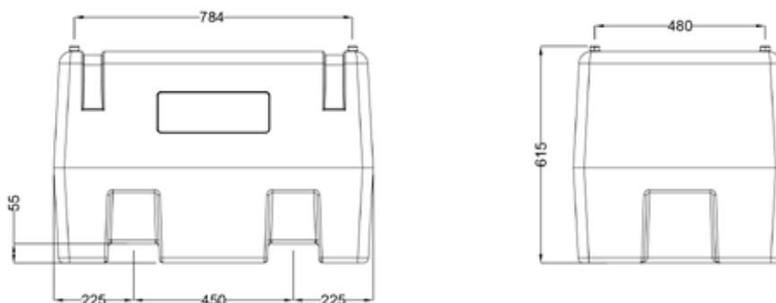
Serbatoio in polietilene rigido per il trasporto AdBlue® per uso privato, con unità di trasferimento integrato composto da pompa elettrica autoadescante a membrana disponibile in diverse tensioni (12-24V). Tubo di mandata Ø 19 mm lunghezza 4 m di lunghezza e pistola automatica. Il sistema è disponibile a 440 litri e può essere integrato con contaltri digitale. Il serbatoio è dotato di tappo di carico da 2" con sfiato integrato.
