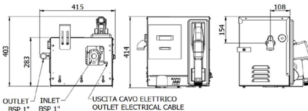
Sistema di travaso gasolio ad uso privato, consente un rifornimento degli automezzi pulito e veloce, oltre alla misurazione e registrazione delle quantità erogate. Dotato di portapistola con microswitch per marcia / arresto pompa, pistola automatica con raccordo girevole e portatubo estraibile frontale. Struttura predisposta con apposito e robusto piedistallo.
