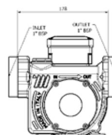
Elettropompe 230V, autoadescanti a palette di tipo volumetrico, sono equipaggiate con motore elettrico asincrono a induzione autoventilato con grado di protezione IP55, classe di isolamento tipo F, con termica di protezione. Valvola by-pass e filtro in acciaio inox integrati.
