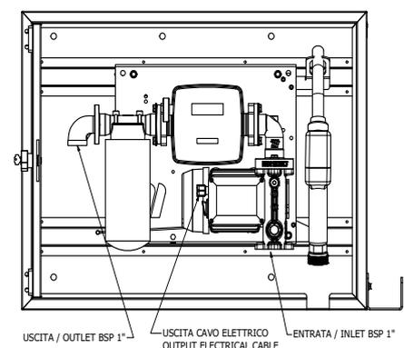
Solido armadietto in lamiera verniciata anti-corrosione completo di chiusura a chiave, il gruppo pompa erogatore è alloggiato all'interno con supporti anti-vibranti. Dotato di pistola automatica con raccordo girevole, contalitri, filtro separatore. Sistema di travaso gasolio ad uso privato, consente un rifornimento degli automezzi pulito e veloce, oltre alla misurazione e registrazione delle quantità erogate.
