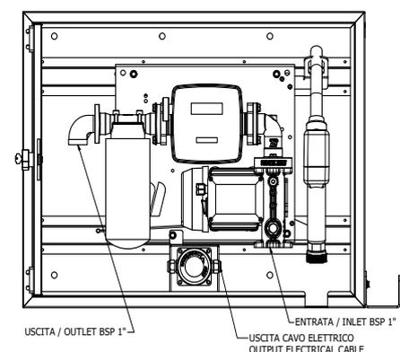
Solido armadietto in lamiera verniciata anti-corrosione completo di chiusura a chiave, il gruppo pompa erogatore è alloggiato all'interno con supporti anti-vibranti. Dotato di pistola automatica con raccordo girevole, contalitri, filtro separatore.
