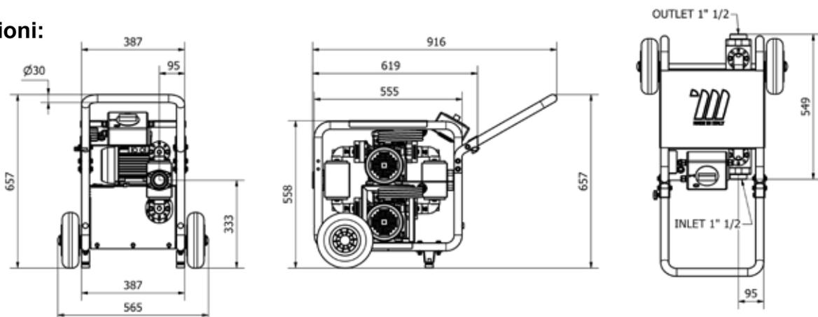
Sistema di travaso gasolio ad uso privato, consente un rifornimento degli automezzi pulito e veloce, oltre alla misurazione e registrazione delle quantità erogate. Dotato di portapistola con microswitch per marcia / arresto pompa, pistola automatica con raccordo girevole e portatubo estraibile frontale. Struttura predisposta per il fissaggio a muro, su serbatoi cisterna o su apposito piedistallo.
