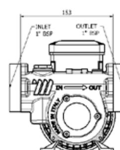
Elettropompe 115V - 230V, autoadescanti a palette di tipo volumetrico, sono equipaggiate con motore elettrico asincrono a induzione autoventilato con grado di protezione IP55, classe di isolamento tipo F, con termica di protezione. Valvola by-pass e filtro in acciaio inox integrati.
