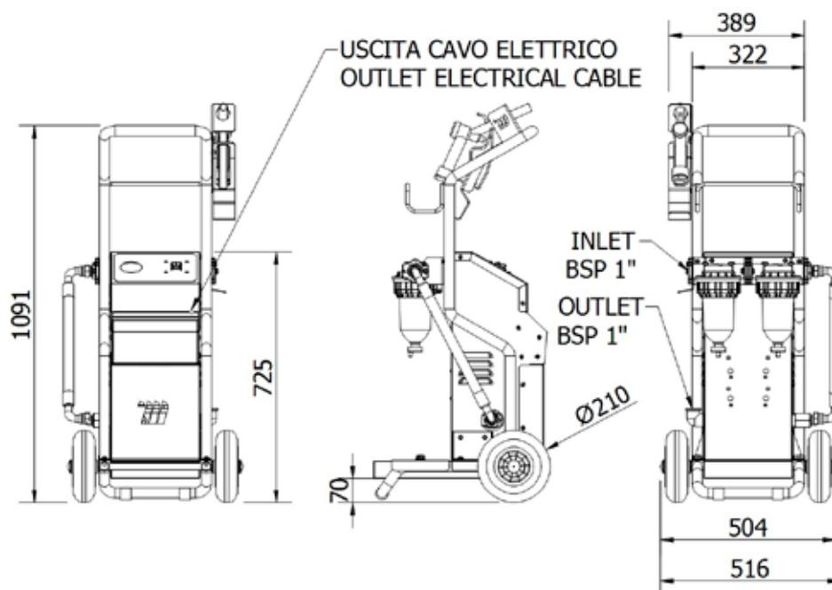
Gruppo filtrante con doppia filtrazione per olio assorbendo impurità. L'elevata efficienza permette il filtraggio di ingenti quantità di olio con una unica operazione. Primo stadio con capacità filtrante pari a 125  $\mu$ , secondo stadio con capacità filtrante pari a 10  $\mu$  per impurità. Gruppo dotato di tubo mandata e tubo di aspirazione. Ruote di grande diametro ed adatte agli spostamenti su qualsiasi superficie, robusta struttura in tubolare verniciato.
