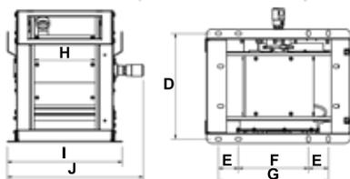
Avvolgitubo automatico a molla in acciaio verniciato progettato per applicazioni che richiedono solidi equipaggiamenti anche a bordo di autocarri adatto per ospitare tubi flessibili di Ø massimo 1.1/2", per la distribuzione di aria compressa, olio e affini e carburanti. Sono progettati per avere due posizioni di uscita tubo diverse, una superiore e una inferiore.
