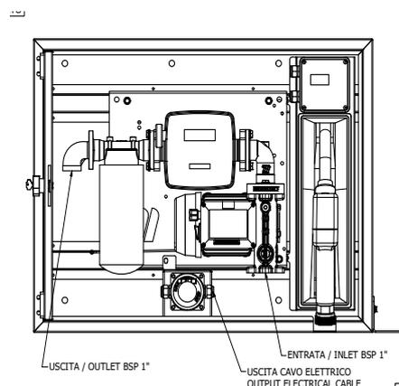
Solido armadietto in lamiera verniciata anti-corrosione completo di chiusura a chiave, il gruppo pompa erogatore è alloggiato all'interno con supporti anti-vibranti. Dotato di pistola automatica con raccordo girevole, contalitri, filtro separatore, pulsante emergenza.
