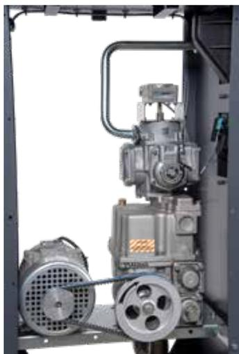
Unità pompante rotativa volumetrica autodescante ad ingranaggi
