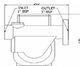
Elettropompe per batterie a 12 o 24V a corrente continua, a palette autoadescenti costituite da corpo in ghisa, girante in acciaio sinterizzato e palette in resina acetlica.
