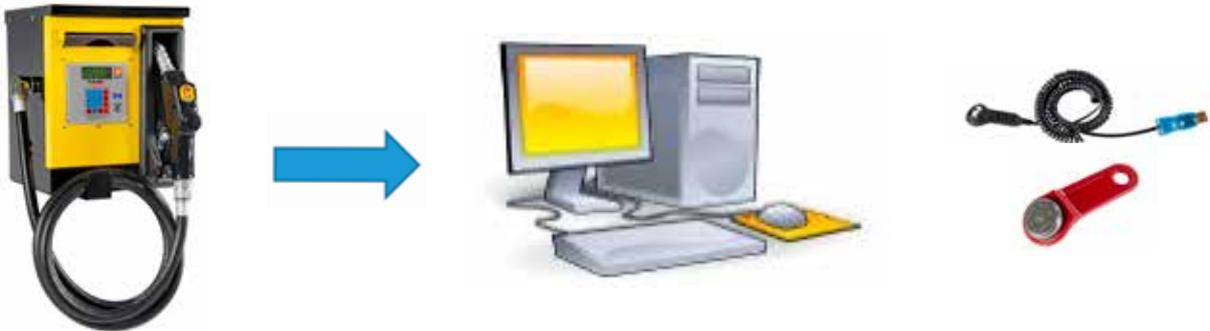
**OPZIONE 2 / KIT DI COMUNICAZIONE VIA CAVO:** Cavo di connessione LAN per la connessione diretta con il PC e con il software MecGest. Anche in questo caso è possibile scaricare i dati relativi alle erogazioni e abilitare nuovi codici utente con la connessione diretta via cavo. L'identificazione degli utenti e degli automezzi ai fini dell'erogazione avviene mediante codice PIN.
