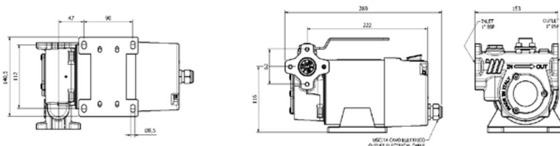
Elettropompe 230V, autoadescanti a palette di tipo volumetrico, sono equipaggiate con motore elettrico asincrono a induzione autoventilato con grado di protezione IP55, classe di isolamento tipo F, con termica di protezione. Valvola by-pass e filtro in acciaio inox integrati.
