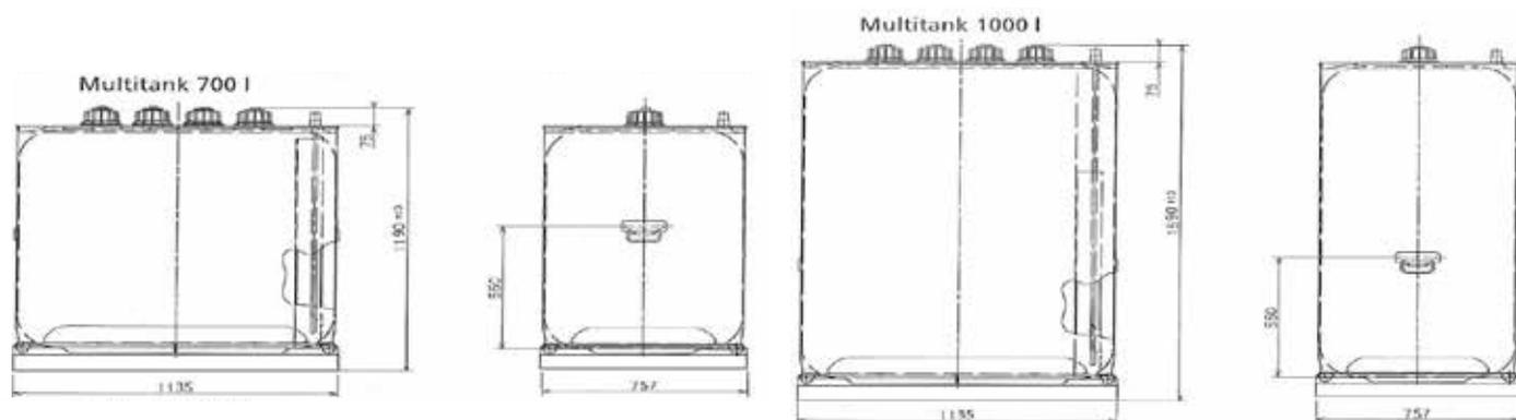
Serbatoio in polietilene rigido per Gasolio e AdBlue® per uso professionale e privato, con doppia camera, benna di ritenzione integrata, protezione UV, barriera antiodore SMP e sigillo di qualità proofed barrier. Staffa per applicazione kit AdBlue® e kit gasolio "Compact".
