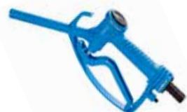
Art. 099-5199-000 Pistola manuale in plastica "AD90" per travaso AdBlue® portata 90 l/min Guarnizioni in Viton Corpo in plastica Raccordo girevole Ø 20
