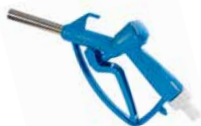
Art. 099-5200-000 Pistola manuale in plastica estremità Inox "MP80" per travaso AdBlue® portata 80 l/min Guarnizioni in Viton Corpo in plastica estremità Inox Portagomma Ø 20
