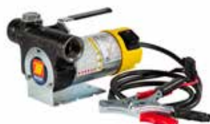
Art. 091-5081-045 Pompa 12V - cavo di alimentazione (sec. 4 mmq. m 4 lunghezza) con pinze e fusibile - 45 l/min
