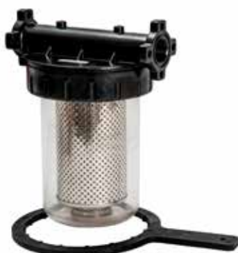
Art. 094-5248-000 Filtro di mandata trasparente separatore d'acqua per gasolio / Benzina 105 l/min Connessione entrata-uscita F1" Capacità filtrante 5 µ
