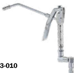
Art. 014-1083-010 Pistola con manguera rígida y boquilla 4 grapas Longitud de la manguera rígida 200 mm Acoplamiento giratorio triple "Z" F 1/4"
