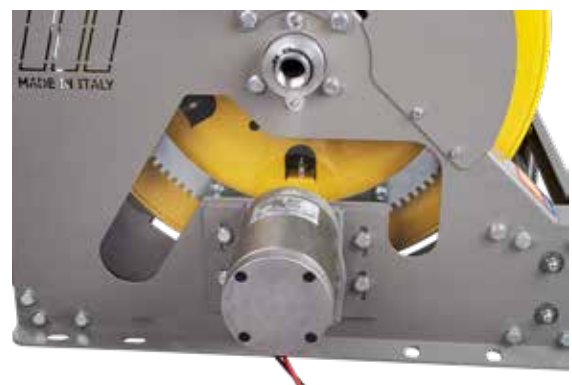
Transmisión motorizada directa con piñón en la corona dentada
