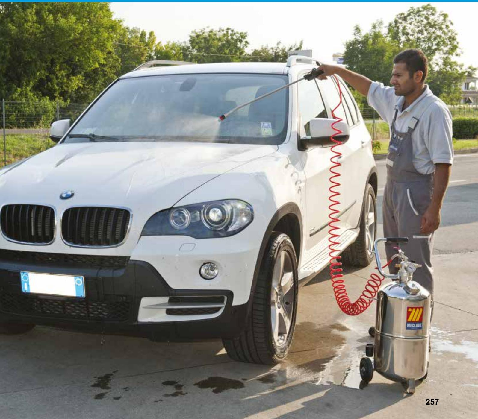
Apparecchi per la nebulizzazione di liquidi detergenti, disinfettanti, oli lubrificanti ed affini a bassa densità. Riempiti di liquido per 3/4 della loro capacità e caricati d'aria a 6-8 bar, funzionano autonomamente senza bisogno del collegamento continuo all'aria compressa.
