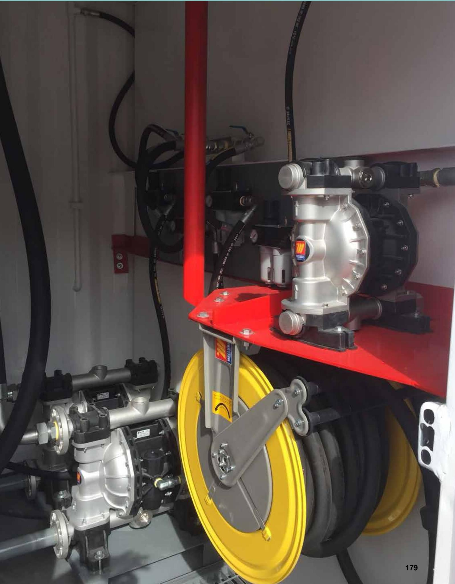
Le pompe pneumatiche a doppia membrana sono da tempo riconosciute come le pompe più flessibili nel trattamento di liquidi aggressivi, a pressioni e portate variabili. La gamma di applicazioni è praticamente illimitata. Le pompe Meclube AODD vengono realizzate in varie taglie, con una vasta gamma di scelta dei materiali di costruzione. Quasi ogni tipo di liquido, da altamente acido e corrosivo, passando per vernici, colle ad alta viscosità, fino ai prodotti alimentari, possono essere pompati.
