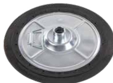
Si consiglia sempre di utilizzare la membrana premigrasso, è indispensabile quando ci sono basse temperature e quando si utilizzano grassi ad alta viscosità. A causa della depressione creata dalla pompa, la membrana viene attirata verso il fondo del fusto, comprimendo il grasso, evitando così cavità d'aria, permette inoltre di raccogliere tutto quel grasso che rimarrebbe sulle pareti e sul fondo del fusto.
