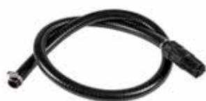
Art. 099-6512-015 Kit aspiración espiral de PU Longitud 1,50 m Manguera espiral de PVC Ø 19x27 Entrada-Salida M 1" BSP Válvula de pie de plástico + filtro Abrazaderas en Inox
